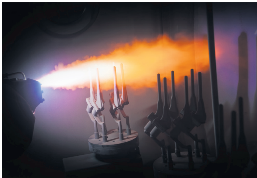
Beschichtungsprozess für Hüftgelenk-Schäfte (Vakuum-Plasma-Spritzen): Der Plasmastrahl hat im Zentrum eine Temperatur von über 10 000 °C und sprüht so das geschmolzene, künstliche Knochenmaterial auf die Oberfläche der Implantate. (Bild Medicoat)
