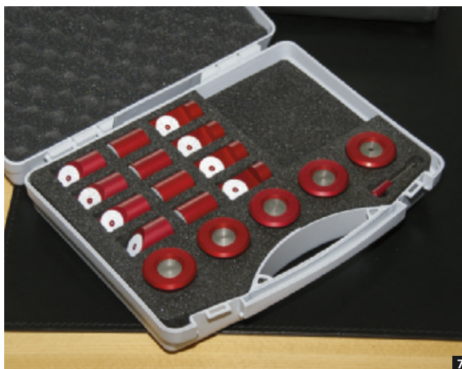
Dieses Lichtmarken-Set für die Laservermessung wurde komplett und inklusive Verpackung bei Werder hergestellt.
